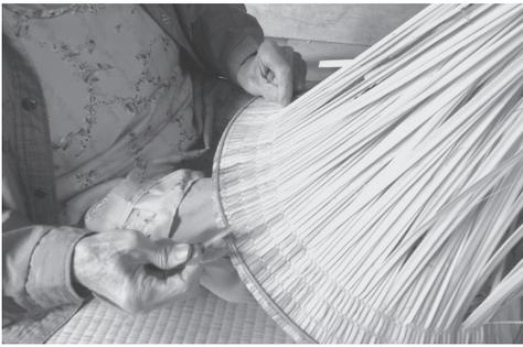
縫う工程。縁取りの工程で骨組みに取り付けたスゲを縫い合わせる。スゲはコワ巻きに縫い付けられているわけではなく、スゲ同士を縫っている。この工程が終わると、コワ巻きの上スゲの層ができる
