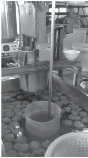
成型機 写真中央左の成型機から落ちたこんにやくを煮ているところ
